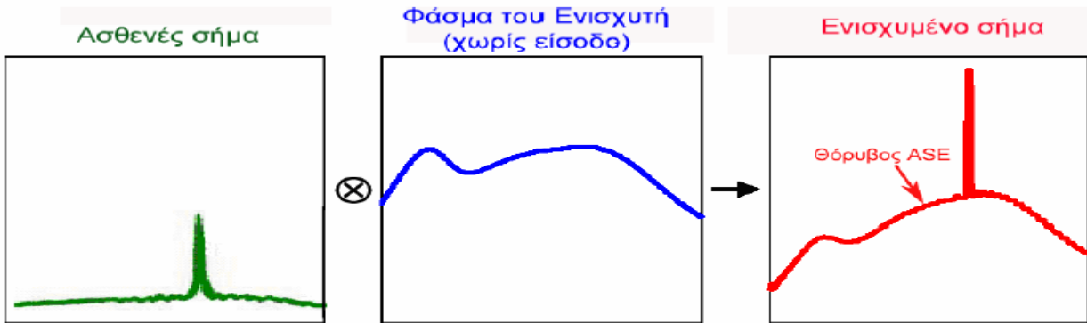
Σχήμα 5. Σχηματική απεικόνιση λειτουργίας του EDFA.
